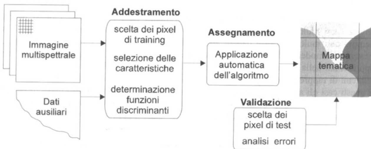
Figura 6. Le tre fasi del processo di classificazione.
