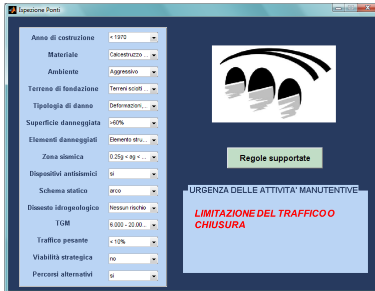
Figura 40 Grado di urgenza per il ponte sul fiume Cassibile
