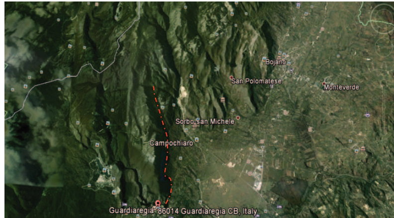
Figura 3.42b: Traccia della faglia di Colli della Defenza vista da Est in un'immagine ripresa da Google Earth; si noti il parallelismo della struttura con quelle di San Polo Matese e di Bojano.
