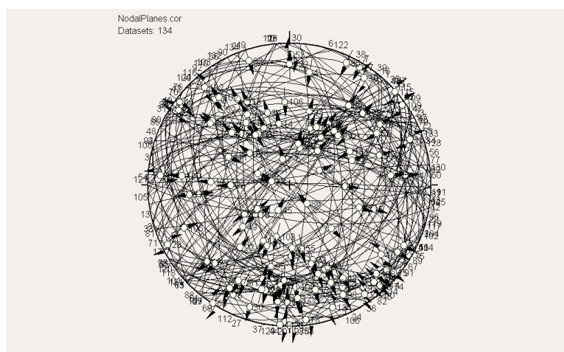
Figura 3.45: Distribuzione dei piani nodali e relativi vettori slip dei meccanismi focali dei 67 eventi meglio registrati della sequenza sismica del 1997 (reticolo di Schmidt, emisfero inferiore).
