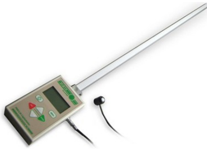
Fig. 4.31 LAI and PAR measurements (AccuPAR LP80 - Decagon).
