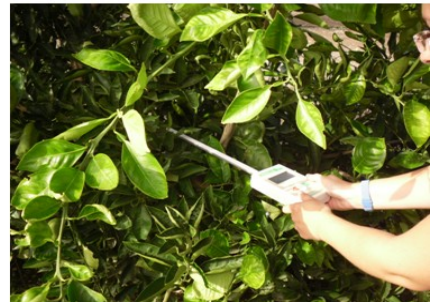
Fig. 4.31 LAI and PAR measurements (AccuPAR LP80 - Decagon).
