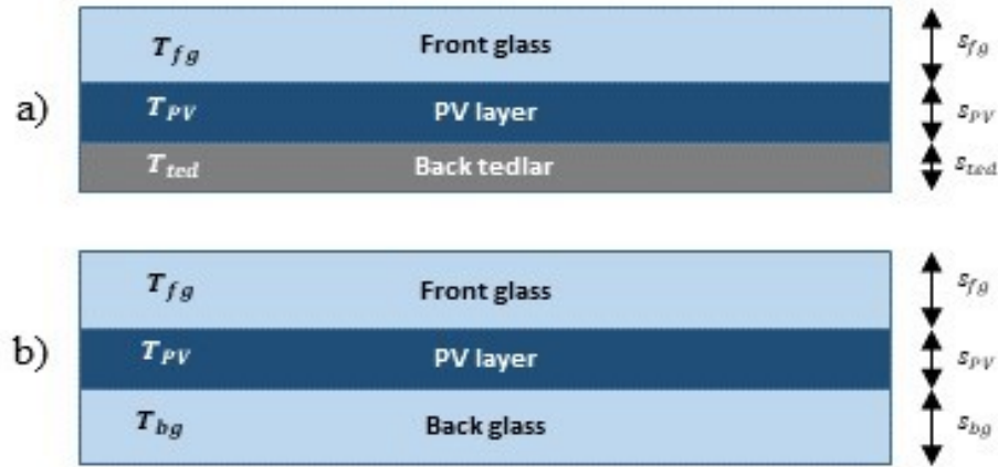
Figure 48 PV module layers: a) monofacial; b) bifacial.
