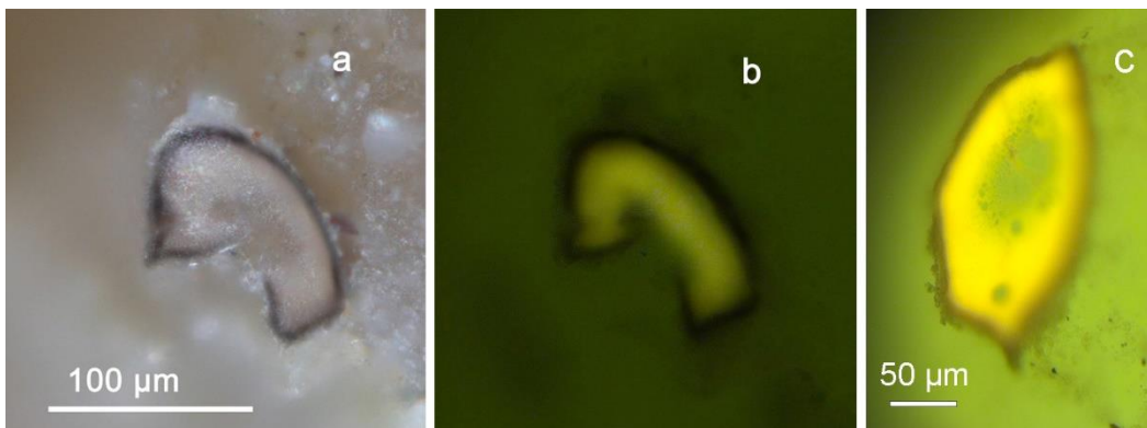
Fig. 93 – a) Punto colla a spot su granulo con superficie esterna di colorazione scura. b-c) Solo la sostanza proteica del biocemento appare giallo brillante in epifluorescenza. Località: Falconara.
