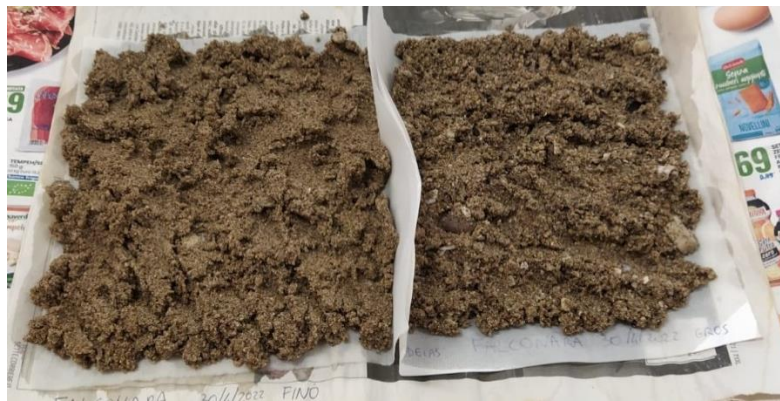
Fig. 27 – Sedimento raccolto nel fondale circostante le biocostruzioni preparato su una base rigida per l'asciugatura in stufa nel Laboratorio di Sedimentologia del DipBioGeo.
