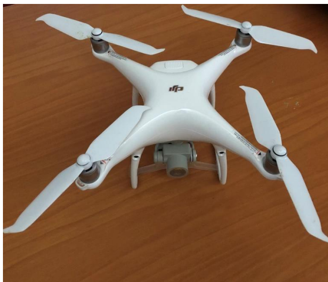
Fig. 26- Il Phantom 4 PRO V2.0 utilizzato per la realizzazione dei rilievi aerofotogrammetrici.
