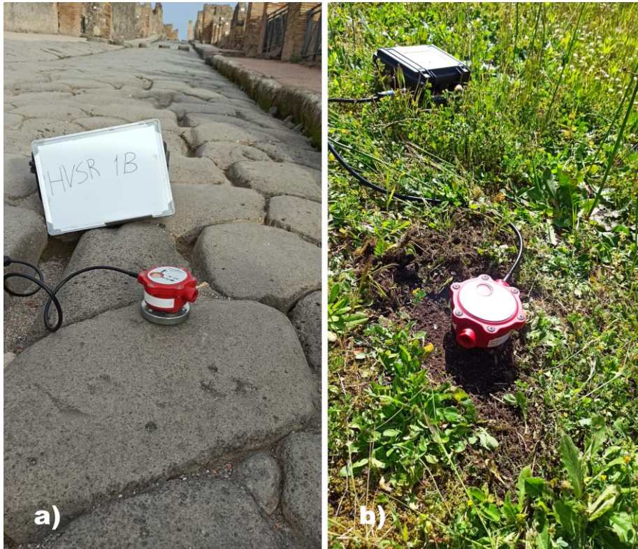
Figura 6.8: Impianto del geofono tri-componente con piastra in acciaio a), con puntoni in acciaio in b)
