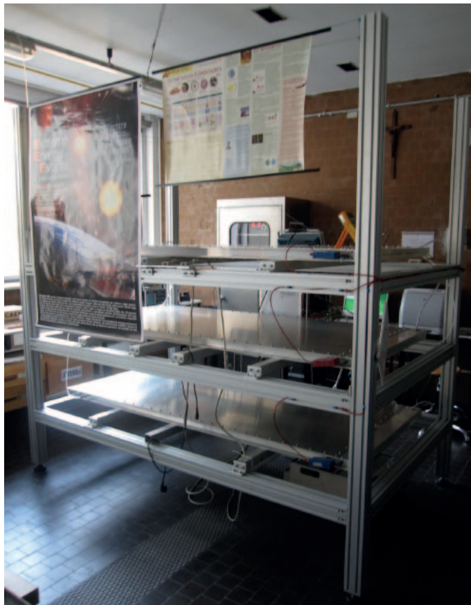
Fig. 1. – Foto di un telescopio del Progetto EEE installato presso il Liceo “M. D’Azeglio” di Torino.
