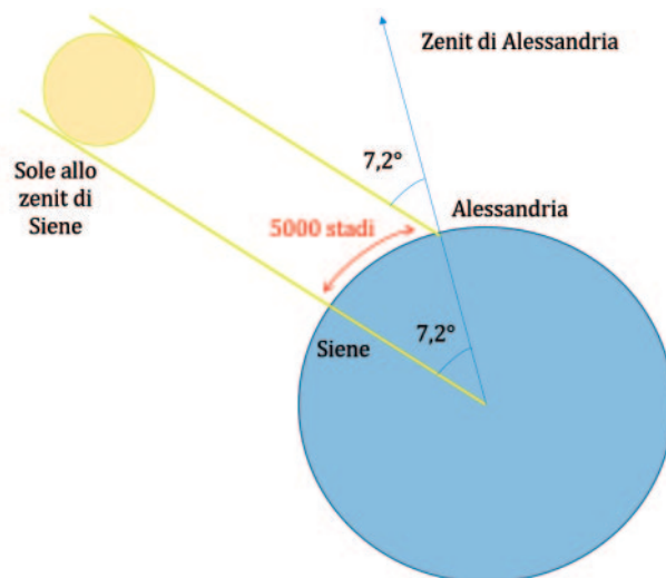
Fig. 3. – Rappresentazione schematica della misura di Eratostene. Nell'immagine, Siene ha il Sole allo Zenit, mentre l'angolo al centro della Terra corrisponde all'angolo \omega citato nel testo (pari a 7,2^\circ nel caso di Siene ed Alessandria).
